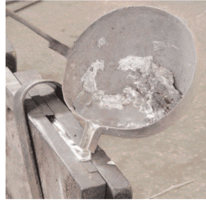
صب مصهور الألمنيوم في صورة بلاطات تمهيداً لدرفرتها
